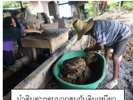
นำดินตะกอนมาผสมกับดินเหนียว
